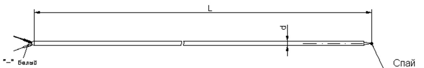
Провод ХА(К) имеет двойную изоляцию из керамоволокна сечением жил 0,5 мм<sup>2</sup>. Максимальная рабочая температура 1200°C.
