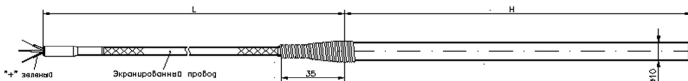
Корпус термопары выполнен из нержавеющей стали 12Х18Н10Т.
