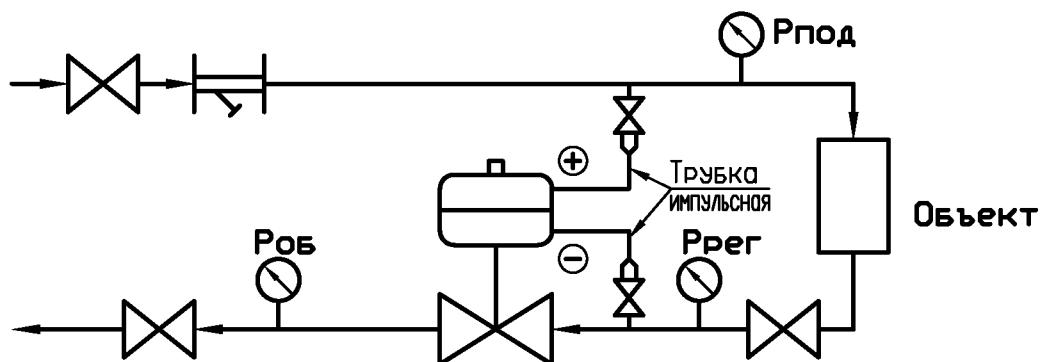
**Схема подключения регулятора давления "после себя"**
