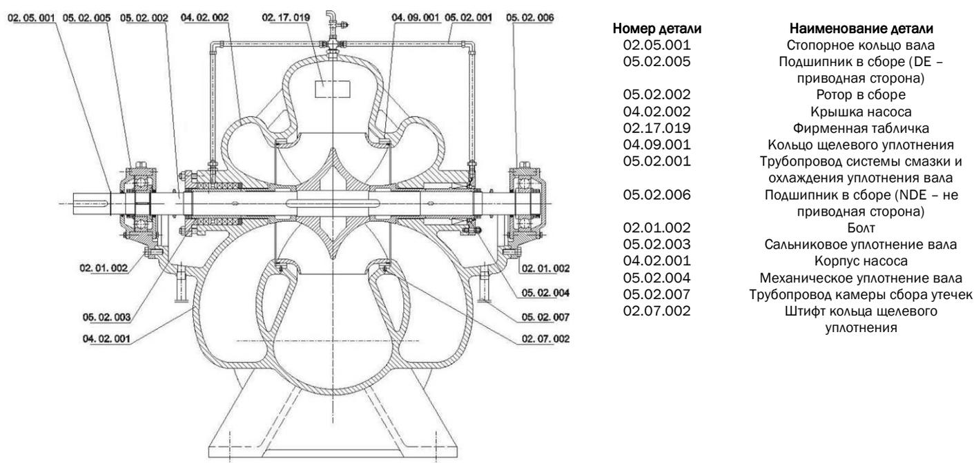
Рис. 10 Конструкция горизонтального насоса тип А
