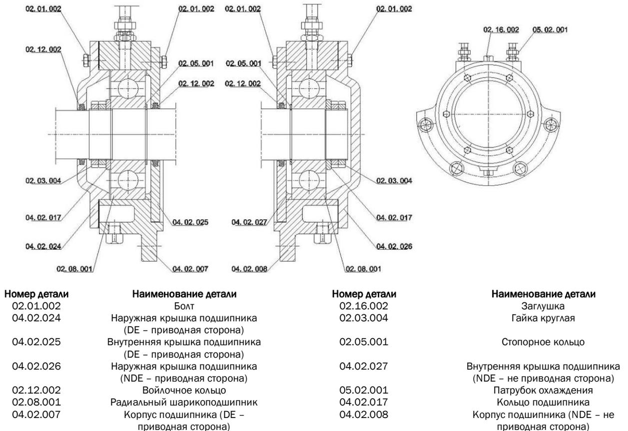
Рис. 26 Подшипники в сборе с принудительным охлаждением
