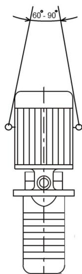
При подъеме агрегата электронасосного CDLK/CDLK(F) строповку производить за строповочные проушины и/или рым-болты (возможно с применением скоб такелажных) по схеме приведенной на рис. 3.
