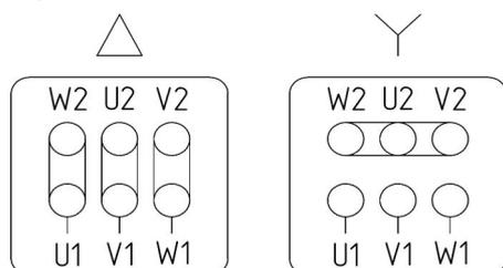
Рисунок 4. Схема подключения фаз электропитания.
