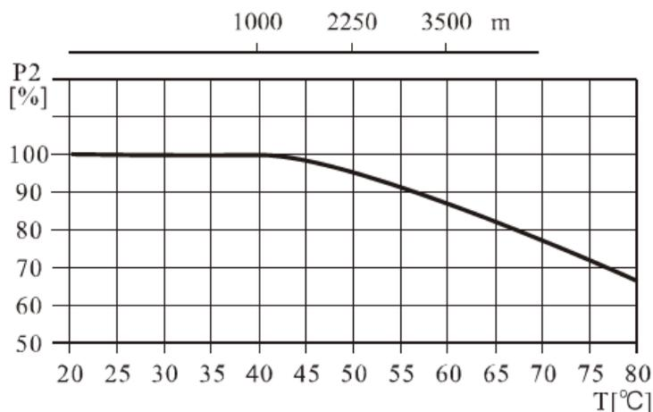
Рисунок 2. Изменение мощности электродвигателя
